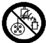
Installare lontano dalla bobina d'accensione e passare il cablaggio lontano dai cavi dell'alta tensione.
